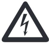
El símbolo del rayo en forma de flecha dentro de un triángulo indica la presencia de tensión eléctrica peligrosa. Deben seguirse las instrucciones con este símbolo. De lo contrario, usted o terceros corren el riesgo de recibir una descarga peligrosa o de provocar un cortocircuito o un incendio. Recomendamos dejar cualquier trabajo únicamente en manos de personal cualificado.
