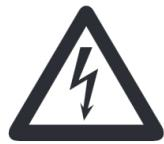
Il fulmine raffigurato come una freccia all'interno del triangolo indica la presenza di tensione elettrica pericolosa. Attenersi obbligatoriamente alle istruzioni previste per questo simbolo. In caso contrario, sussiste per l'utente o per terzi il rischio di scossa elettrica, causando un corto circuito o un incendio. Consigliamo di far eseguire qualsiasi lavoro esclusivamente a personale specializzato e qualificato.
